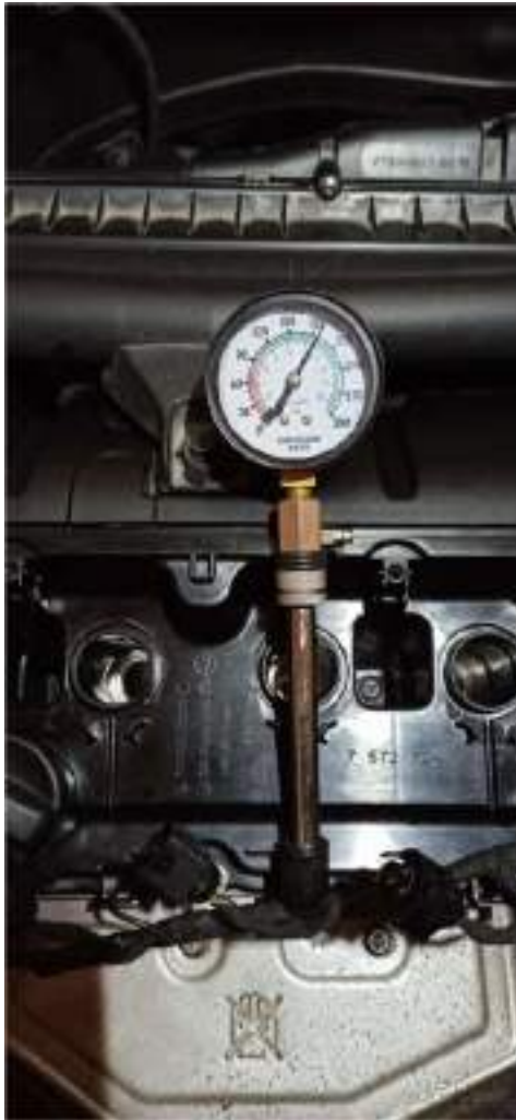
Ilustración 10: Verificación compresión tercer y cuarto cilindro.
