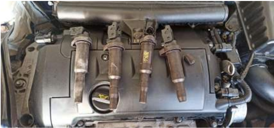
Ilustración 86: Bobinas viejas tras proceder a su cambio.
