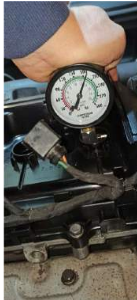
Ilustración 10: Verificación compresión tercer y cuarto cilindro.
