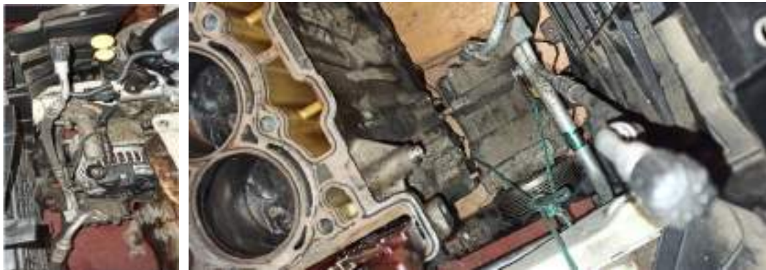
Ilustración 47: Alternador, rodillo tensor y compresor de aire acondicionado antes de ser desmontados (izquierda) y ya desmontados (derecha).
