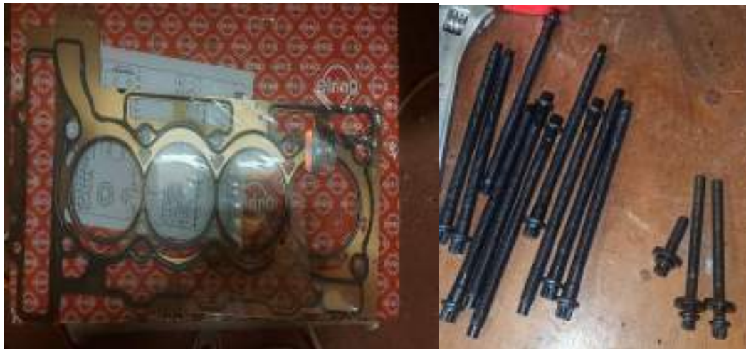
Ilustración 12: Junta de culata y juego de tornillos de culata nuevos adquiridos en Rectificados Castilla.
