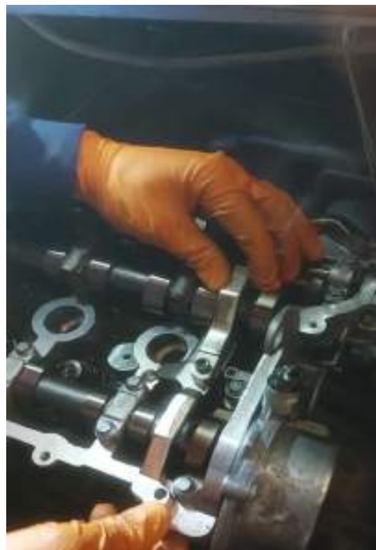
Ilustración 76: Útil de calado de la distribución ya colocado en su posición.
