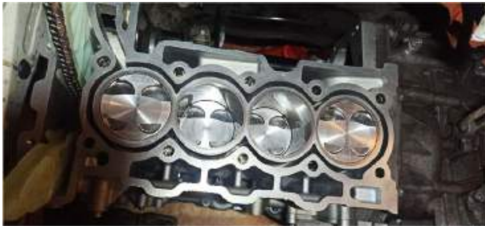
Ilustración 66: Parte baja del motor donado ya introducida en el vehículo y ensamblada con la caja de cambios.
