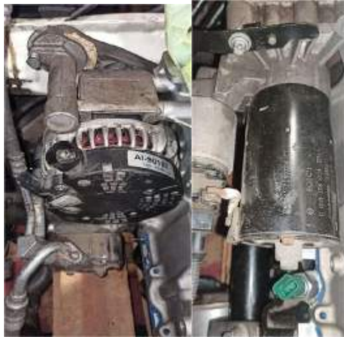
Ilustración 70: Compresor de aire acondicionado; alternador y rodillo tensor de la correa de accesorios ya montados en el bloque (izquierda); y motor de arranque ya montado (derecha).
