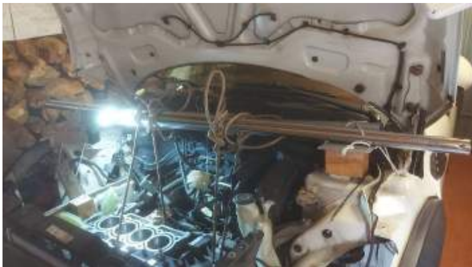
Ilustración 67: Se muestra el despliegue de medios rudimentarios para ayudar a sostener el bloque motor.
