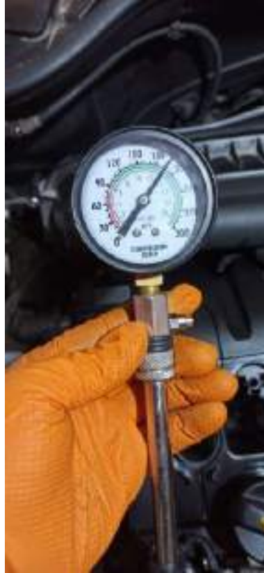
Ilustración 8: Verificación compresión primer cilindro.
