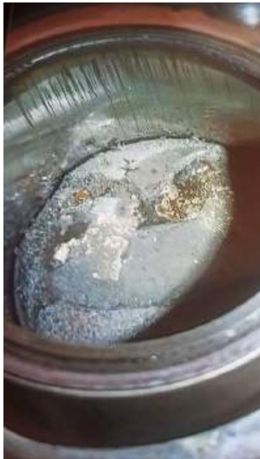
Ilustración 16: Detalle del estado del cuarto cilindro del motor original.
