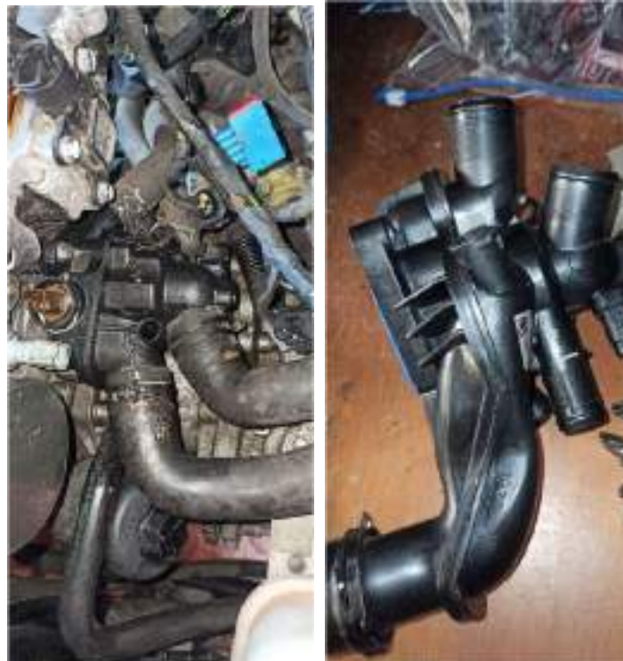
Ilustración 33: Tuberías del líquido refrigerante antes de ser desmontadas (izquierda) y caja del termostato ya desmontada (derecha).
