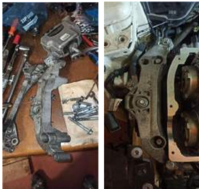
Ilustración 78: Soporte motor derecho y tornillos antes de ser montado (izquierda) y ya montado (derecha)
