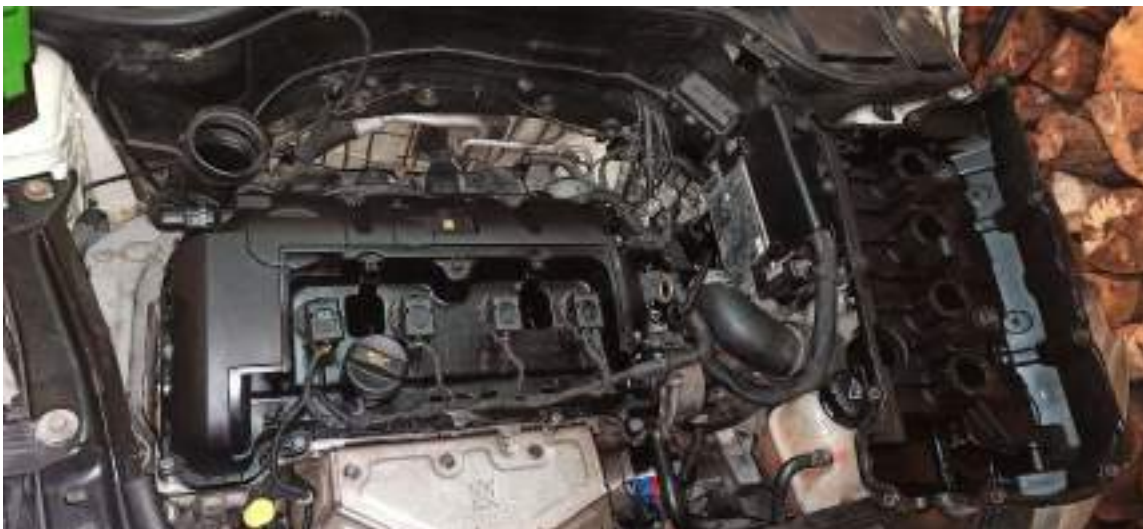
Ilustración 20: Tapa de balancines ya instalada junto a la tapa antigua.
