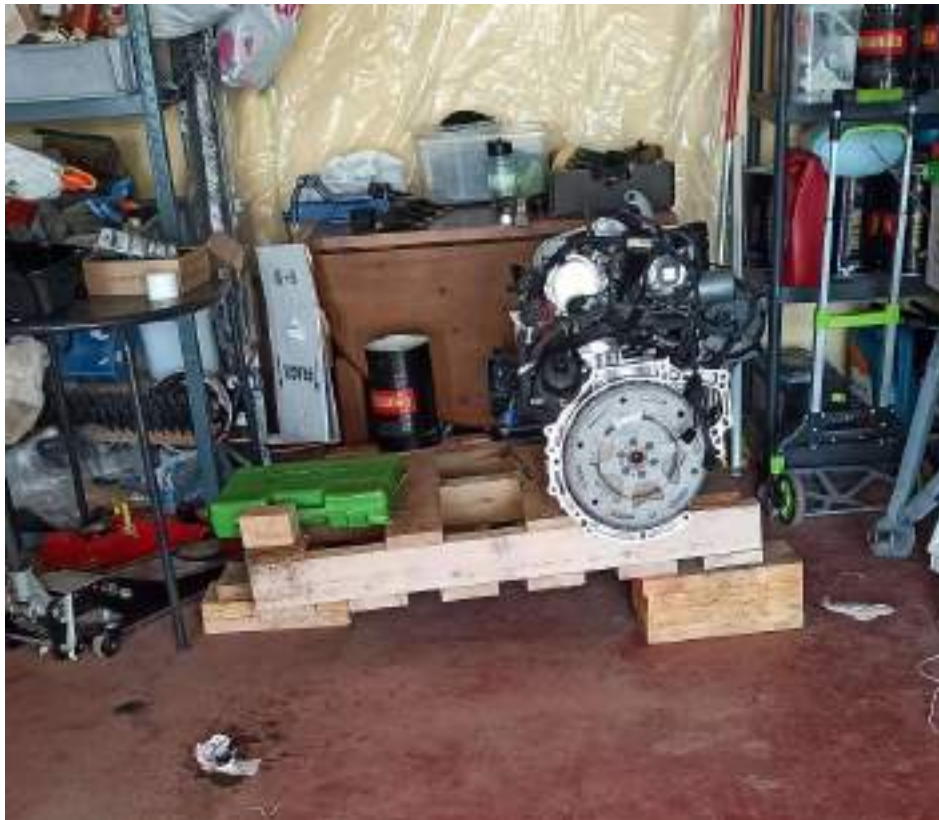
Ilustración 6: Motor donado ya preparado en garaje sobre un soporte.
