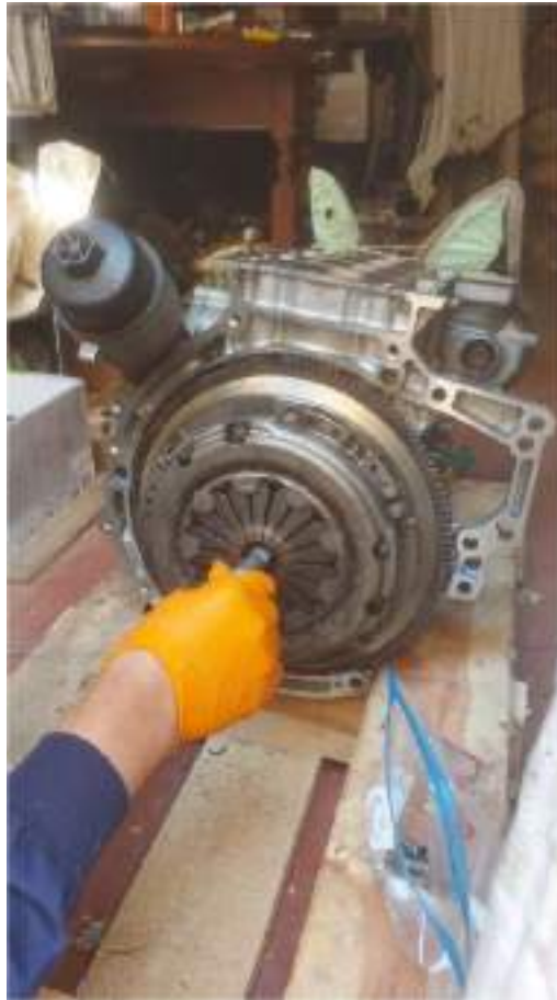
Ilustración 64: Montando el embrague sobre el volante de inercia.
