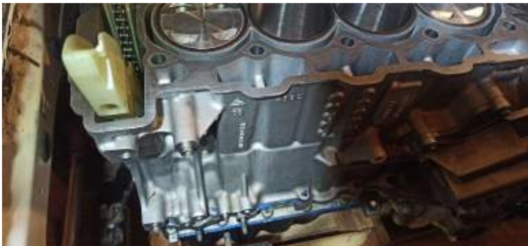
Ilustración 69: Detalle de la parte baja del motor sin accesorios.
