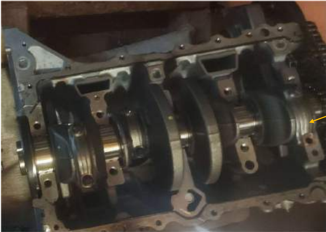
Ilustración 58: Muestra que faltaba un tornillo a los sombreretes de biela.
