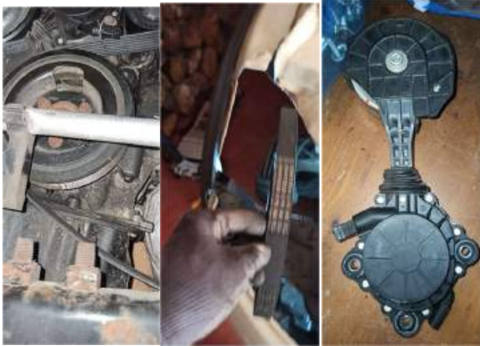
Ilustración 46: Correa de accesorios antes (izquierda) y después (centro) de ser desmontada, y rodillo (derecha).
