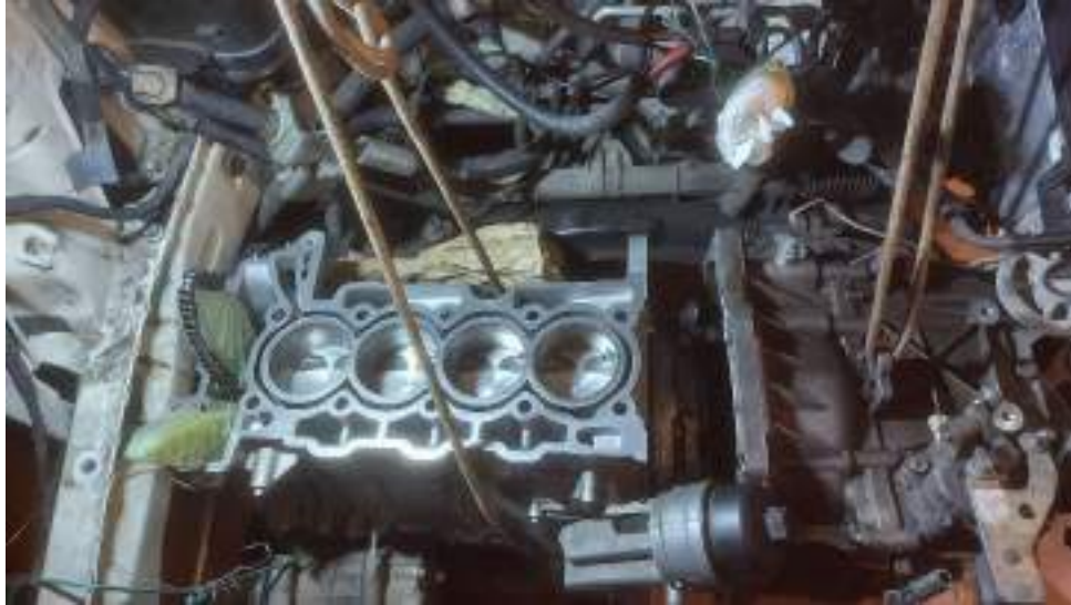
Ilustración 65: Bloque motor ya introducido y justo antes de ensamblarlo con la caja de cambios.
