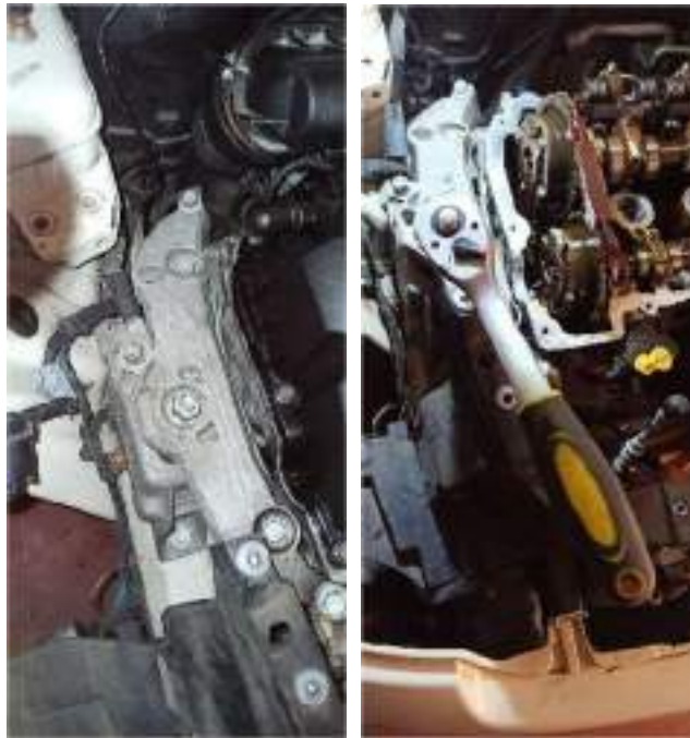
Ilustración 34: Soporte motor antes y durante el proceso de ser desmontado.
