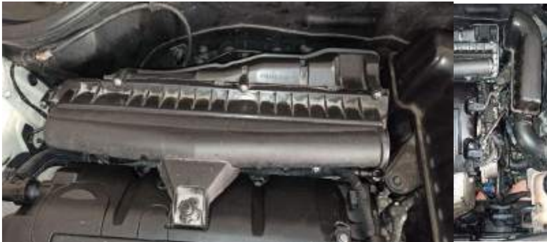
Ilustración 27: Filtro de aire y canalizaciones de entrada de aire al filtro del motor antes de ser desmontado.
