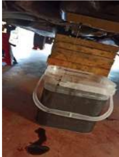
Ilustración 32: Extracción de aceite y al fondo soporte de apoyo con tableros.
