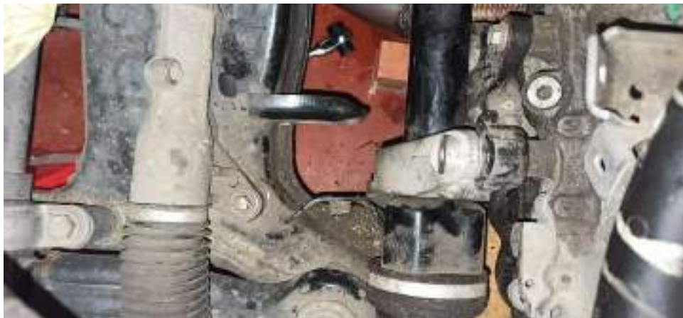
Ilustración 45: Soporte motor inferior y transmisiones en el proceso de ser desmontados.
