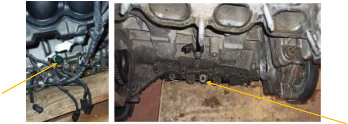
Ilustración 94: Sonda de nivel de aceite del motor donado (izquierda) y tornillo que aparecía en ese lugar en el motor original (derecha).
