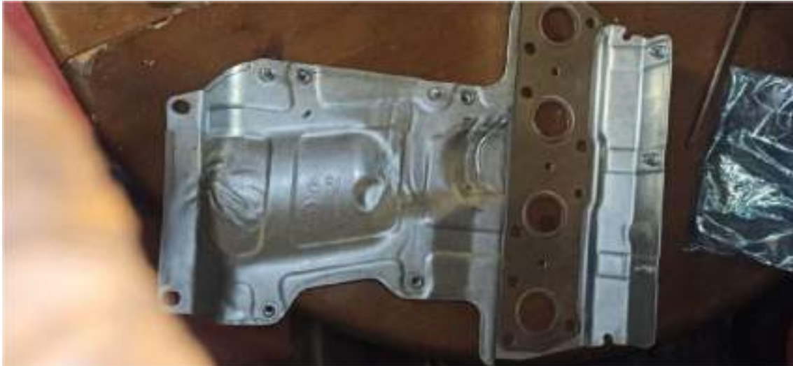
Ilustración 90: Junta del colector de escape.
