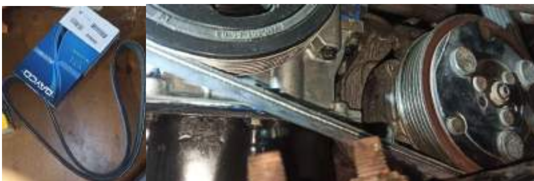
Ilustración 83: Correa de accesorios nueva (izquierda) y una vez montada (derecha).
