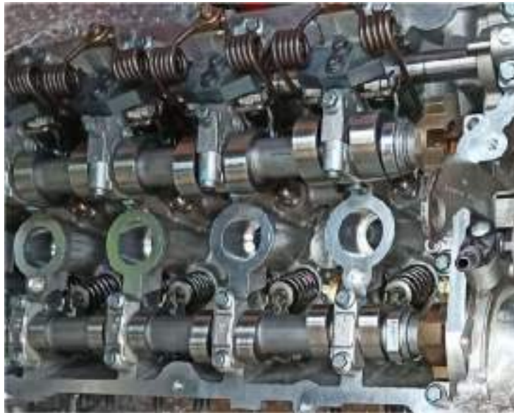
Ilustración 41: Culata del motor donado tras su verificación y montaje correcto en Rectificados Castilla.
