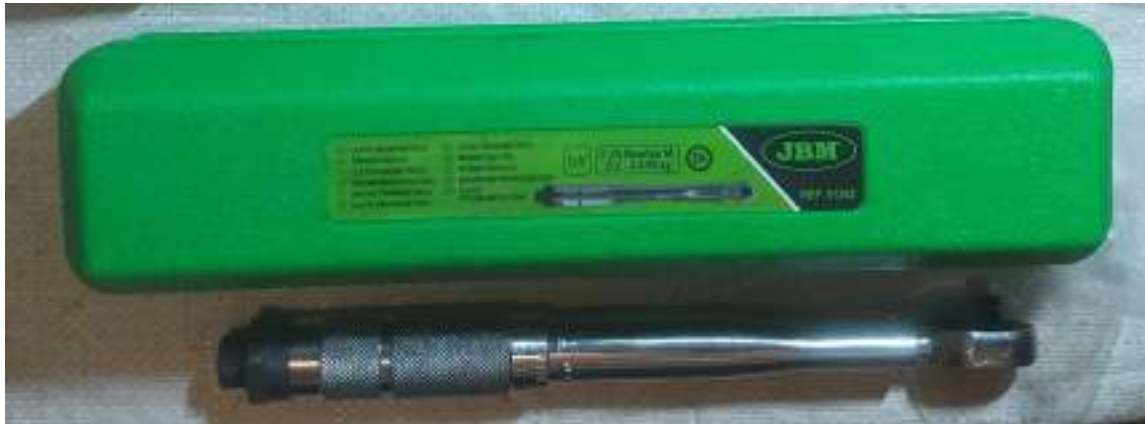
Ilustración 14: Dinamométrica de 2 a 24 Nm comprada para poder realizar el trabajo.
