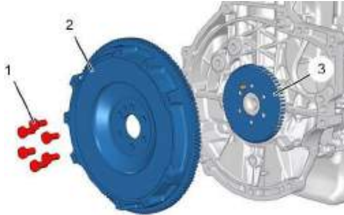
Ilustración 50: Instrucciones de desmontaje del volante motor. Fuente: Manual de Taller.
