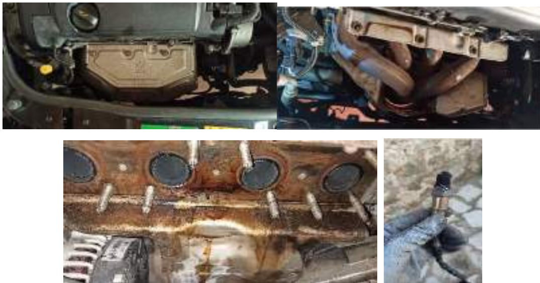
Ilustración 31: Colector de escape antes, durante y después de ser desmontado y sonda lambda desmontada.
