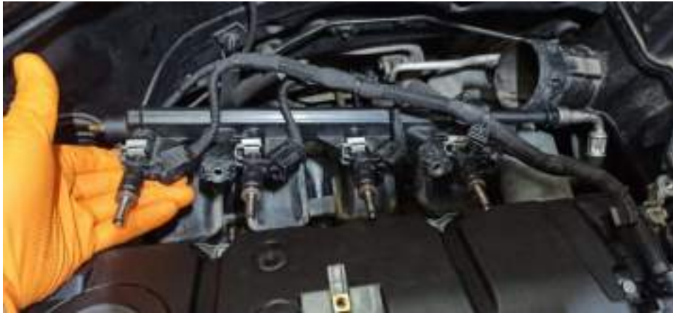
Ilustración 29: Desanclaje de la rampa de inyectores.
