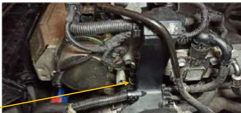
Ilustración 89: Sonda de temperatura de agua sustituida.
