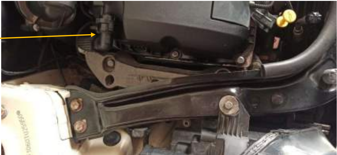
Ilustración 26: Tubo de recirculación de gases (marcado con flecha amarilla).
