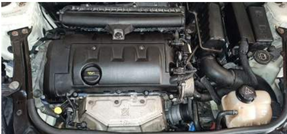
Ilustración 81: Cablería, colector de admisión, colector de escape y filtro de aire ya instalados.
