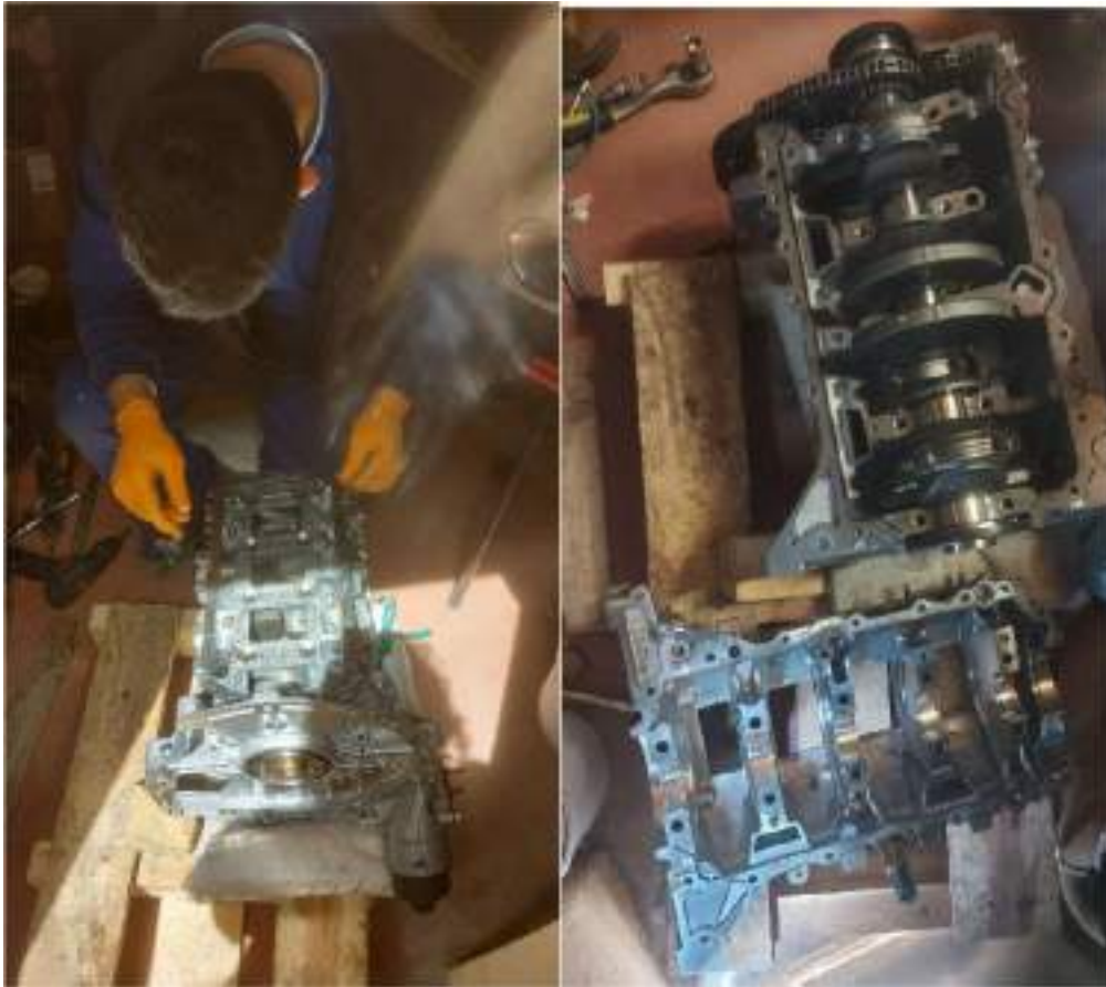
Ilustración 56: Cáster sombrero en proceso de ser desmontado (izquierda) y ya desmontado (derecha).
