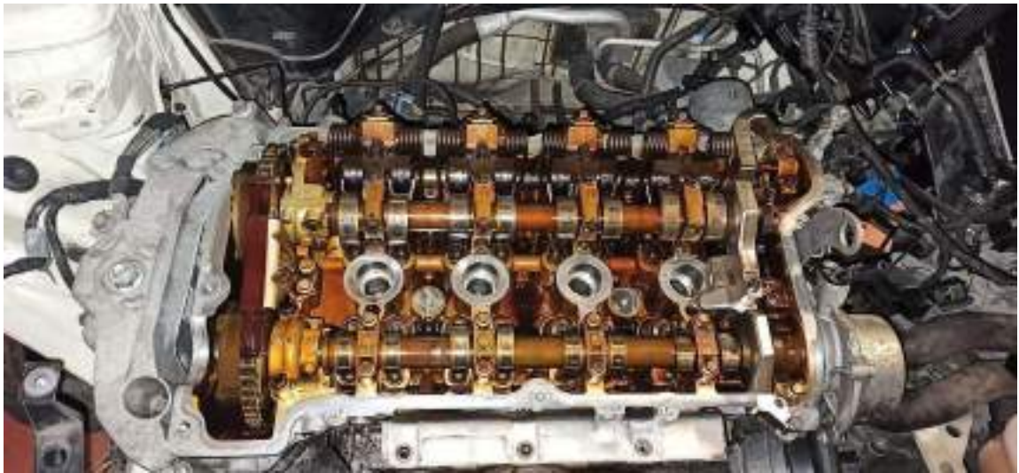
Ilustración 36: Parte superior de la culata tras quitarle la tapa de balancines nueva y con el útil de calado.
