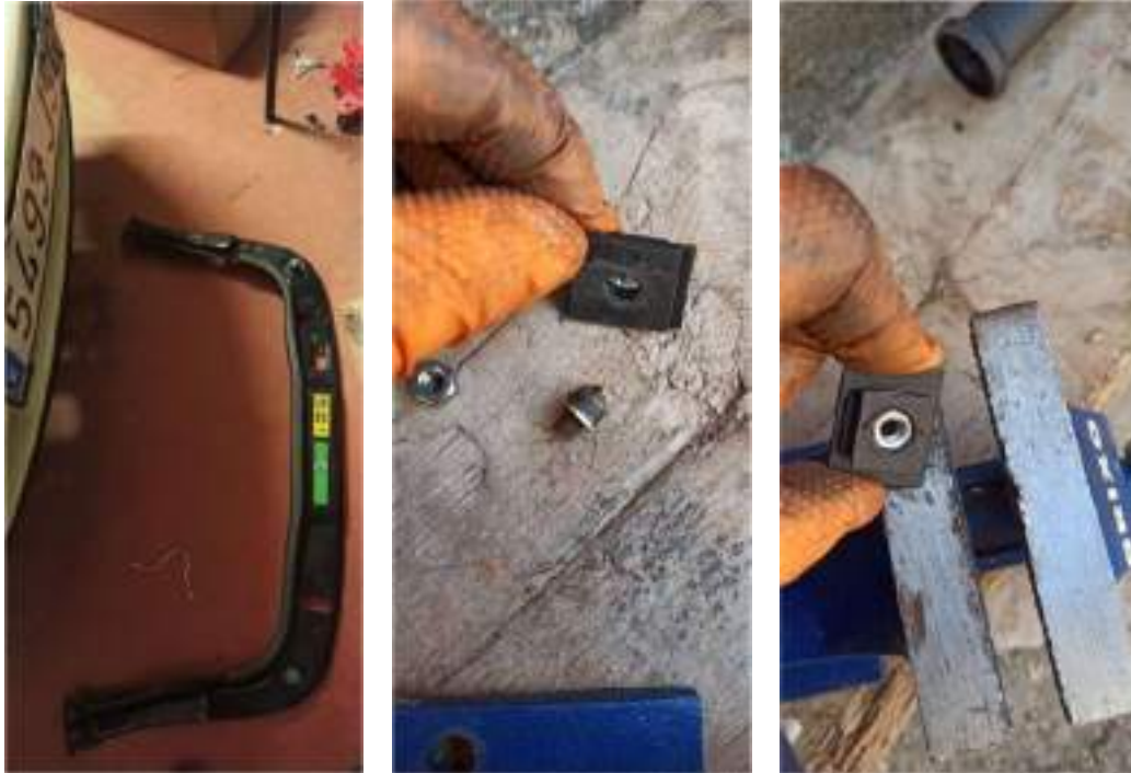
Ilustración 84: Traviesa superior (izquierda); mecanismo del faro delantero roto (centro); y mecanismo elaborado con el tornillo de banco (derecha).
