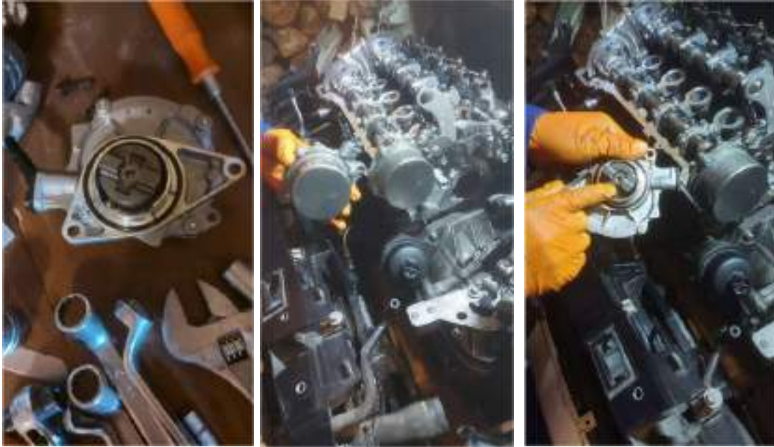
Ilustración 77: Mecanismo de vacío del árbol de levas de escape (izquierda); y ya instalado (centro y derecha).
