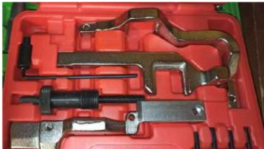
Ilustración 13: Kit de calado del motor.
