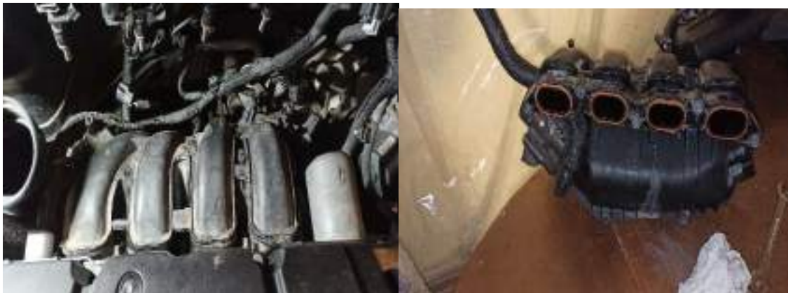
Ilustración 28: Colector de admisión en el vehículo (izquierda) y ya desmontado (derecha).
