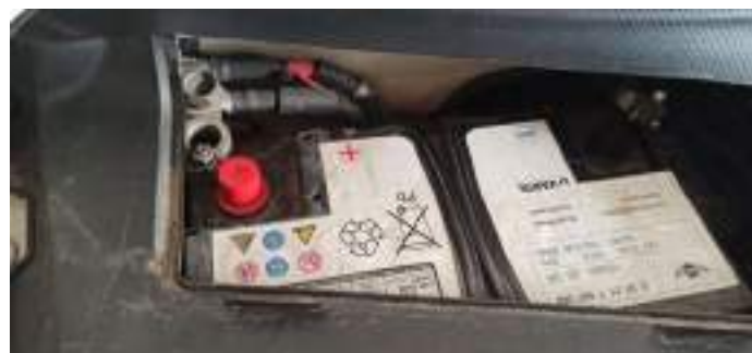
Ilustración 23: Batería del vehículo tras ser desconectada.
