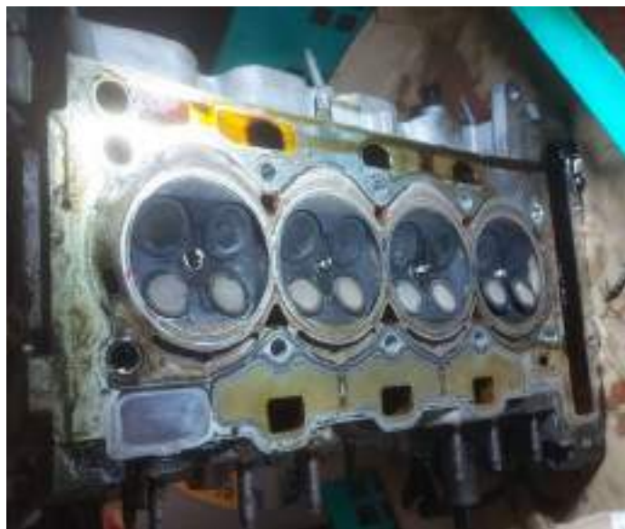
Ilustración 38: Parte inferior de la culata original.
