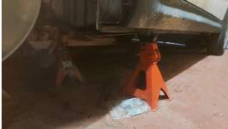
Ilustración 24: Borriquetas situadas en los puntos reforzados del vehículo.
