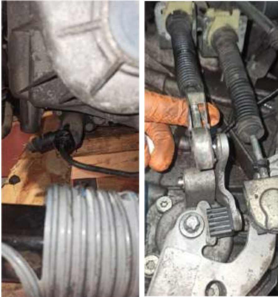
Ilustración 82: Canalización del líquido de freno que acciona el cilindro del embrague (izquierda) y mecanismos de sujeción de los cables de la selección de marchas (derecha).
