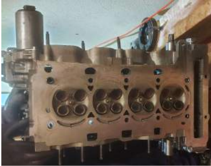
Ilustración 39: Parte inferior de la culata donada.
