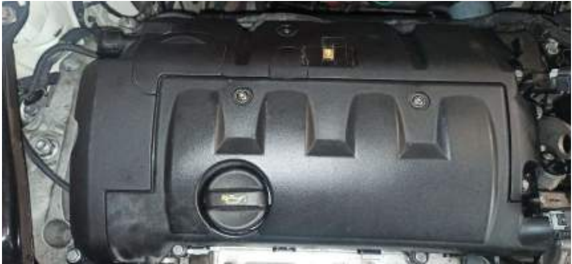
Ilustración 79: Tapa de balancines ya instalada.
