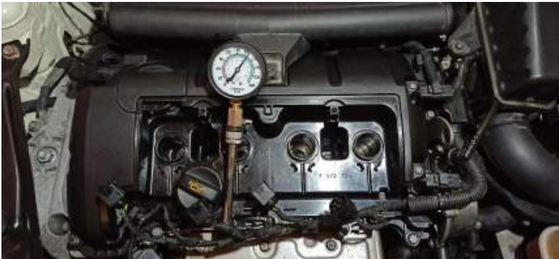
Ilustración 9: Verificación compresión segundo cilindro.
